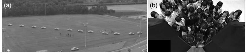
図 8 (a) 車のブレーキによる擾乱伝播の観測実験 [13]. 楕円状のサーキットを一様に走行している 12 台の先頭車がブレーキを踏んだとき, その影響が後続の車にどのように伝わっていくかが観測された. (b) 群集の避難実験 [19] (NHK サイエンス ZERO). 図中央下部の出口から人が一斉に脱出しようとし, 出口が詰まっていることが分かる.
